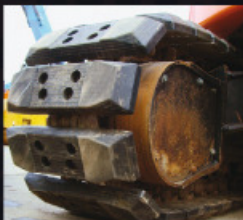
Chain on Type Befestigung mittels Schrauben direkt auf dem Kettenstrang
