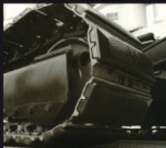
Bolt On Type Befestigung mittels Schrauben auf der Stahlbodenplatte
