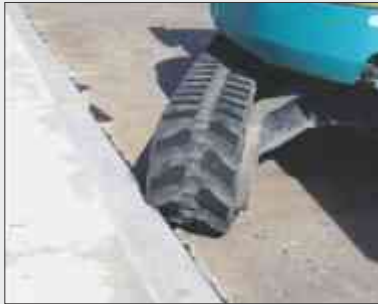
Mögliche Ursache für Kantenbrüche
