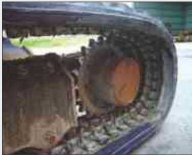
Detracking am Kettenrad
