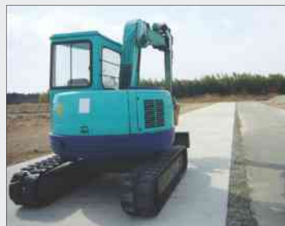
Durchführung eines Tests auf dem Testgelände in Tochigi (Japan) unter Benutzung einer 5,3 Tonnen-Maschine auf Asphalt.
